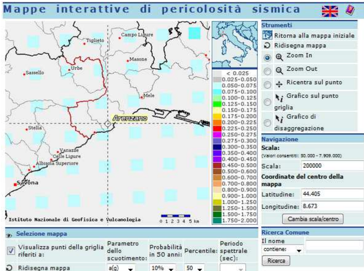
Fig. n° 6: accelerazioni al bedrock con probabilità di superamento del 10 % in 50 anni (tratta dal sito internet dell' INGV, Progetto DPC-INGV-S1).
